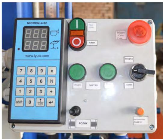
Micron-4 предназначен для автоматизации технологического процесса распиловки на горизонтальных ленточных пилах. С его помощью автоматизируются практически все технологические операции по управлению механизмом подъема и опускания пилы при распиловке. Увеличивает производительность на 10-15% и увеличивает общий процент выхода пиломатериалов.
